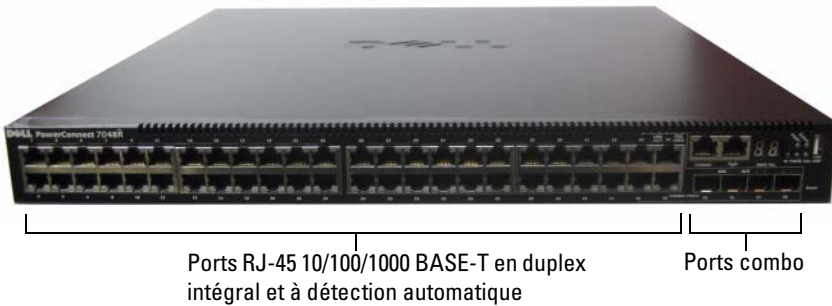
Figure 1-6. PowerConnect 7048R avec 48 ports 10/100/1000 BASE-T
